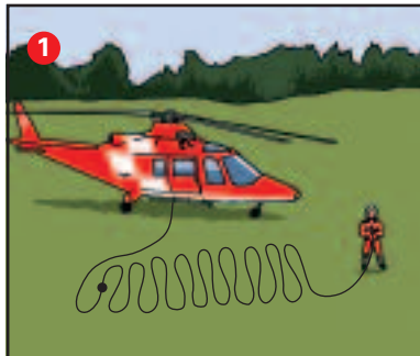
Das lange Seil ist am Lasthaken des Helis befestigt und liegt säuberlich ausgelegt am Boden. Der SAC-Retter klinkt sich am Seilende ein.
