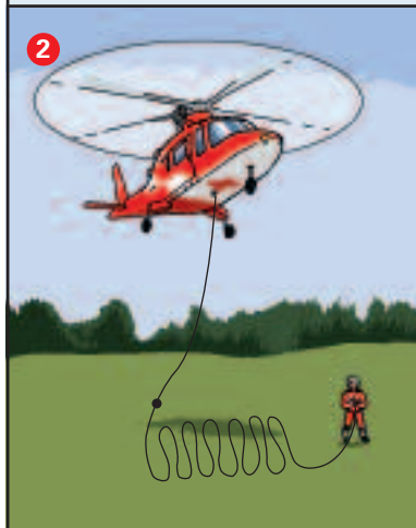
Der Helikopter startet und strafft das Seil, bis der Retter am Seilende abhebt.
